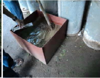
Hình 2. Chất keo tụ được thêm vào bùn.
