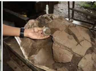
Hình 6. Sự hình thành chất lắng bên trong Geotube.
