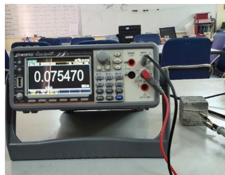
c) Xác định điện trở của mẫu sử dụng dòng điện một chiều với 2 điện cực đo
