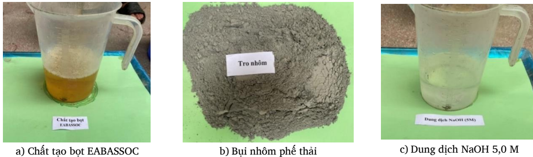
Hình 3. Hỗn hợp chất điều khiển quá trình tạo khí.
