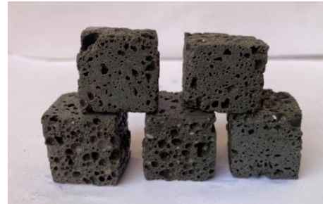
b) Mẫu bê tông hình lập phương 30*30*30 mm
