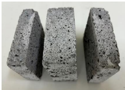
a) Các mẫu bê tông dạng tấm mỏng 150*150*30 mm
