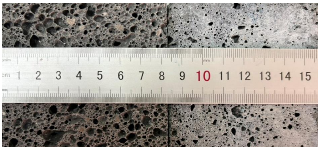
Hình 6. Cấu trúc và phân bố lỗ rỗng tổ ong đồng đều trong mẫu bê tông nhẹ đối chứng.
