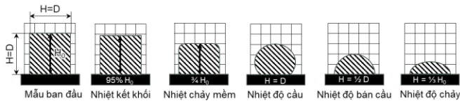
Hình 2. Cách xác định khoảng biến mềm từ phân tích ảnh của KHVĐN.
