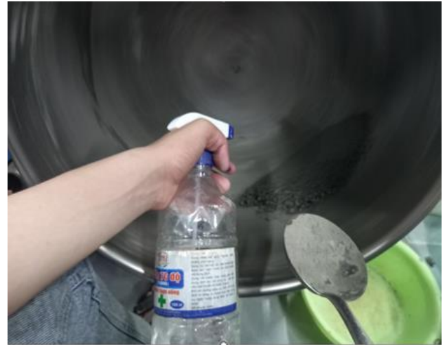
Hình 3. Phương pháp tạo hình FAA bằng thiết bị đĩa quay.
