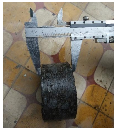
Hình 5. Xác định chiều dày mẫu bằng thước kẹp.
