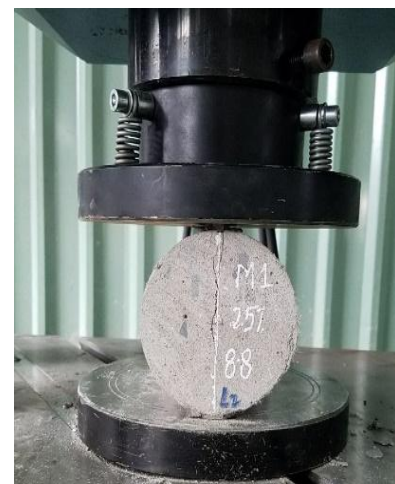
Hình 4. Thí nghiệm ép chẻ.
