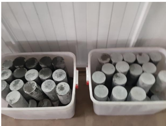
Hình 2. Mẫu bê tông kích thước 100x200 mm.
