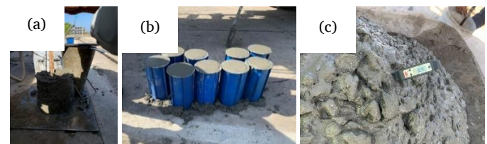
Hình 5. Các thí nghiệm hiện trường đối với hỗn hợp bê tông: (a) thử độ sụt theo TCVN 3106:2022 [12], (b) lấy mẫu bê tông theo TCVN 3105:2022 [13], và (c) đo nhiệt độ trước khi tiến hành đổ khối bê tông.
