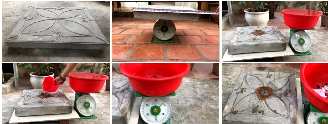
Hình 6. Nghiên cứu thử nghiệm khả năng chứa nước của gạch thu nước thông minh.
