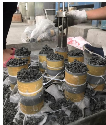
Hình 2. (a) Mẫu bê tông tươi; (b) Đám bê tông vào mẫu trụ D90 x H150 mm.
