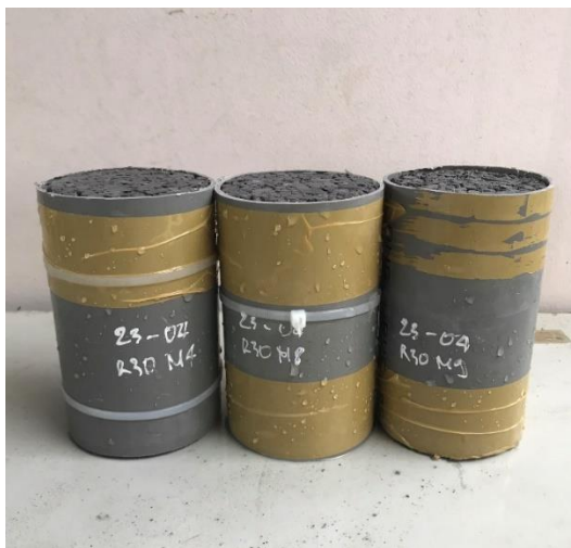
Hình 2. (a) Mẫu bê tông tươi; (b) Đám bê tông vào mẫu trụ D90 x H150 mm.
