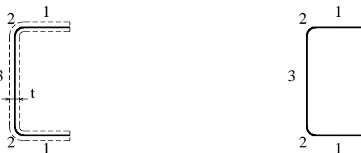
Hình 1. Đường trung bình để xác định đặc trưng hình học của tiết diện cấu kiện được tạo hình nguội.
