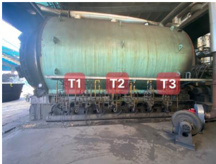
Hình 1. Lò nhiệt phân -Vỏ lò bằng thép A515.
