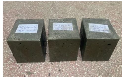
Hình 9. Mẫu bê tông thí nghiệm hình lập phương kích thước 10x10x10cm.
