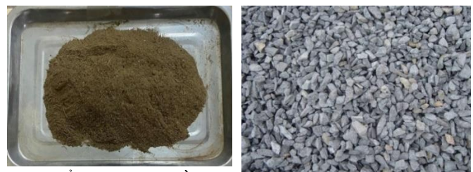
a. Cát biển khu vực TP. Hồ Chí Minh đã sàng b. Đá dăm 5 ÷ 10 mm
