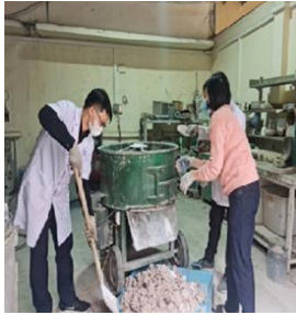
(b) Trộn dẻo nguyên liệu (c) Đùn ép viên trụ Hình 3. Quá trình chế biến và đồng nhất nguyên liệu.
