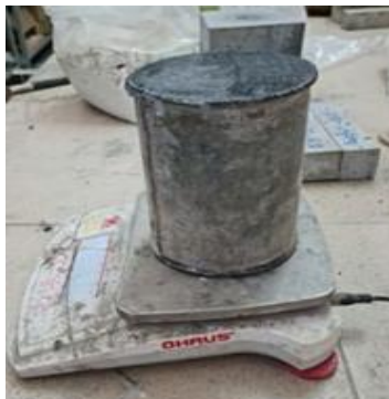
Hình 5. Thí nghiệm đổ đông phối liệu dạng rời sau khi trộn.
