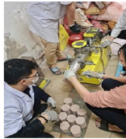
(b) Trộn dẻo nguyên liệu (c) Đùn ép viên trụ Hình 3. Quá trình chế biến và đồng nhất nguyên liệu.
