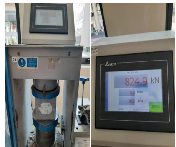
Hình 6. Nén mẫu 3 (Sản phẩm nghiền từ bê tông sàn).
