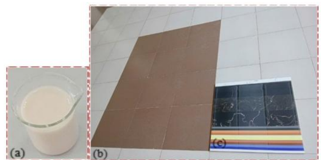
Hình 2 (a,b,c). Hình ảnh chụp của hồ men vi tinh thể chế tạo (a), gạch men ốp lát thường (b) và gạch men ốp lát ceramic được phủ men vi tinh thể theo quy trình chế tạo (c).
