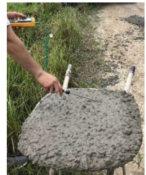
(c) Đo nhiệt độ bê tông trước khi đổ
