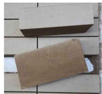
c) Gạch cách nhiệt sau khi đóng rắn và tháo khuôn
