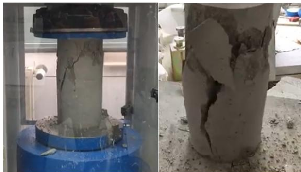
Hình 2. Thử R_n và dạng vết nứt sau khi nén.
