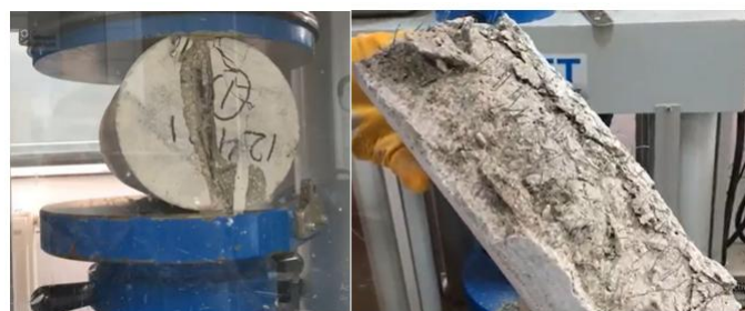
Hình 4. Thí nghiệm xác định cường độ kéo khi ép chế.
