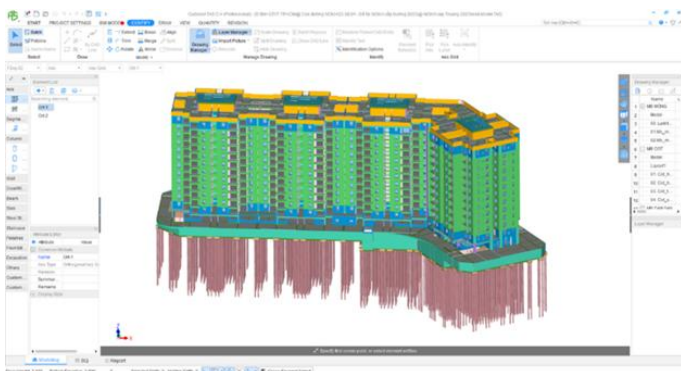
Hình 5. Mô hình BIM từ phần mềm Cubicost (TAS) đưa vào thực nghiệm (nguồn tác giả).
