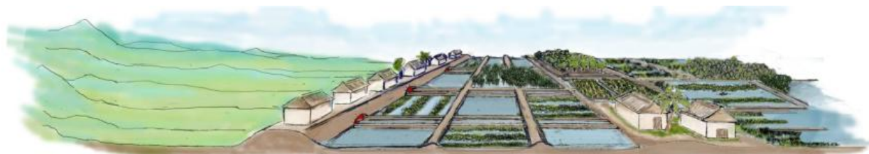
Hình 4. Minh họa kiểm soát lũ lụt ở Thượng nguồn, sử dụng các cánh đồng ngập nước để nuôi cá vào mùa mưa hoặc hình thức "rau nổi" ( Nguồn: Mekong Delta plan).
