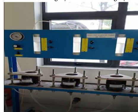
Hình 8. Thí nghiệm kiểm tra thấm.
