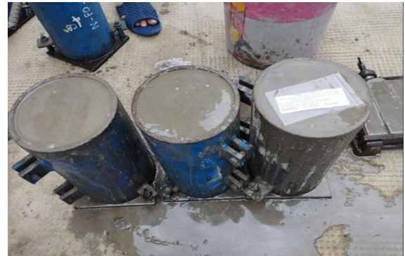
Hình 5. Quá trình đúc mẫu lần trụ.
