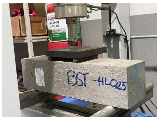
Hình 8. Thí nghiệm chịu kéo uốn mẫu BST-HL0,25.
