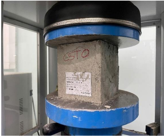
Hình 7. Thí nghiệm chịu nén mẫu CSTO.
