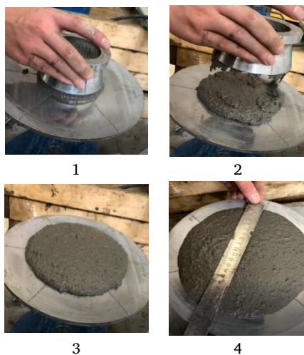
Hình 5. Xác định độ chảy xòe của hỗn hợp bê tông hạt mịn ngay sau khi trộn.
