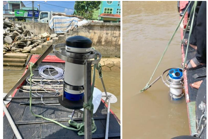
Hình 3. Chuẩn bị thiết bị ADCP Sentinel V-20.
