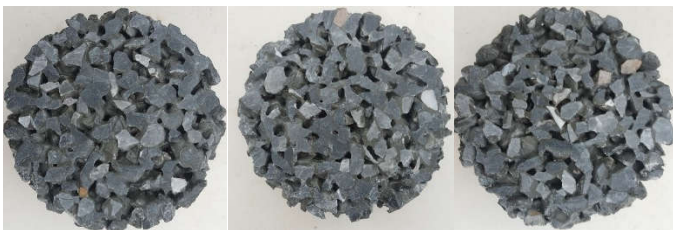
Hình 5. Mặt cắt mẫu theo chiều cao, khi sử dụng hỗn hợp CKD CP3, độ rỗng thiết kế 20%, cốt liệu sử dụng (5-10) mm
