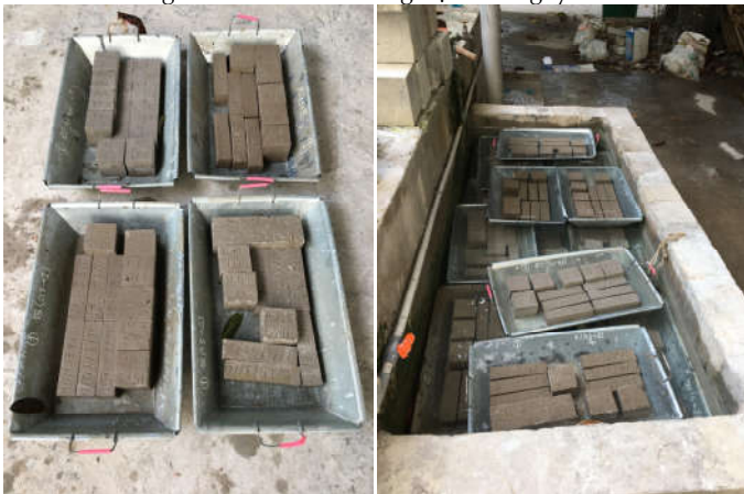
Hình 3. Ngâm bảo dưỡng mẫu thí nghiệm
