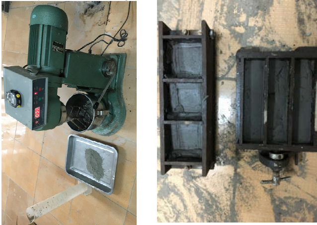
Hình 2. Trộn và chế bị mẫu nén và mẫu uốn hỗn hợp xi măng đất. Các mẫu sau khi chế bị 3 ngày sẽ được tháo khuôn và ngâm nước bảo dưỡng đến thời điểm thí nghiệm 28 ngày.
