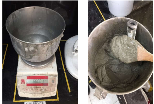
Hình 2. Cân và trộn mẫu vữa cấp C1 – MV1 và cấp C2 – MV2.
