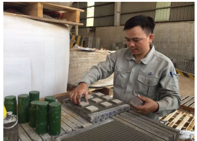
Hình 3. Tạo mẫu thử nghiệm trên sàn bê tông.
