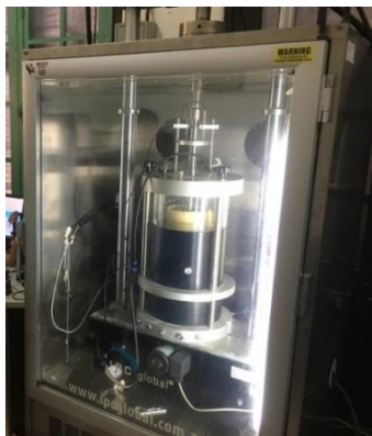
Hình 1. Máy thí nghiệm mô đun đàn hồi của cấp phối đá dăm.
