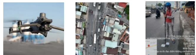
(a) Thiết bị bay (b) Ảnh chụp thu được mm (c) Đo mốc khống chế Hình 2. Thu thập dữ liệu.
