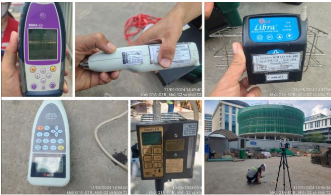
Hình 1. Các thiết bị chuyên dụng quan trắc môi trường định kỳ của công trường.
