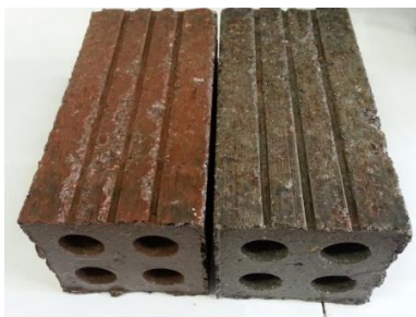
Hình 2. Gạch không nung chứa bùn đỏ (bên trái) và không chứa bùn đỏ (bên phải).
